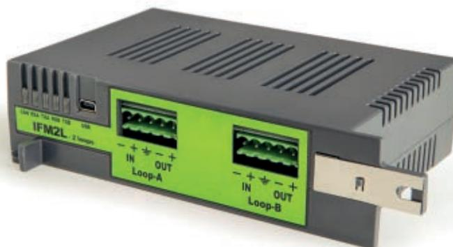
Los módulos de la serie IFM se instalan en la barra CAN DRIVE incorporada en los armarios (máx. 8 módulos IFM por cada armario) según las funciones necesarias.
