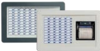
Módulo con 50 LED de 3 colores como el artículo FPMLED, más una impresora térmica sobre rollo de 80 mm. Permite imprimir los eventos registrados por el sistema en tiempo real. Si se coloca en la ranura superior, se instala en el panel frontal y se conecta a la barra CAN DRIVE, mientras que si se coloca en la ranura inferior se conecta al módulo FPM de la ranura superior.
