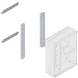
Par de estribos para el montaje del armario distanciado de la pared. Este accesorio permite obtener un espacio de 5 cm entre la pared trasera del armario y la pared donde se fija, para el paso de cables.
