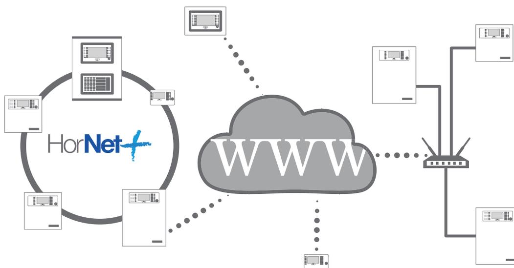
Todos los paneles de control se pueden interconectar en una red mediante conexiones basadas en RS-485 (tecnología HORNET +) o en redes TCP-IP: esto permite la administración deslocalizada de todo el sistema y logra una mayor flexibilidad en el sitio de instalación y una mayor confiabilidad general.
