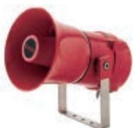
Sirena de alta potencia en protección antideflagrante para señalizaciones acústicas en áreas con atmósferas explosivas.- Categoría 2 (para zonas de tipo 1 y 2). - Aprobación ATEX. - Ex II 2G EEx IIC T4.
