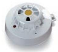
Detector de temperatura analógica en contenedor de bajo perfil de color blanco, preparado para la instalación de bayoneta en la base direccionada. Con led de señalización de estado y salida remota capaz de suministrar 17 mA máx. Construido con protección anti-extracción.
