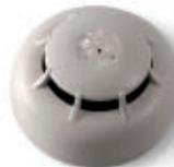
El detector combina la detección de humo y de temperatura para proporcionar (según el modo de uso) una excelente sensibilidad capaz de detectar cualquier tipo de foco de incendio (focos críticos como incendio de líquidos inflamables que producen poco humo) o un grado alto de inmunidad a falsas alarmas. El modo de funcionamiento puede ser configurado directamente por la central, eligiendo entre las siguientes:
