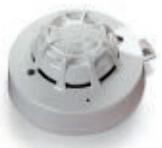
Detector óptico de humo y de temperatura integrados, con inteligencia incorporada, en contenedor de bajo perfil de color blanco, preparado para la instalación de bayoneta en la base direccionada. Con led de señalización de estado y salida remota capaz de suministrar 17 mA máx. Cámara óptica desmontable para facilitar la limpieza y el mantenimiento. Construido con protección anti-extracción.
