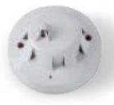
Detector de monóxido de carbono y temperatura, adecuado para la detección de focos si combustión (detección de CO) y de focos con llama (detección térmica). Ideal para las habitaciones de hoteles, donde. La presencia de vapor podría provocar falsas alarmas de los detectores de humo ópticos.
