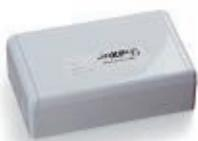
Módulo una salida supervisada adecuada para conectar sirenas y campanas. La salida está controlada tanto contra la interrupción como contra cortocircuito línea. Requiere para la alimentación de la carga, un alimentador exterior adicional. La interfaz está dotada de una entrada NA/NC de avería para el control del alimentador adicional. La interfaz es sensible a la polaridad de alimentación del bucle. Con aislador incluido.
