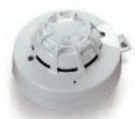
Detector óptico de humo y de temperatura analógico en contenedor de bajo perfil de color blanco, preparado para la instalación de bayoneta en la base direccionada. Con led de señalización de estado y salida remota capaz de suministrar 17 mA máx. Cámara óptica desmontable para facilitar la sustitución o la limpieza. Certificaciones EN54/pt7 y pt5 VDS.
