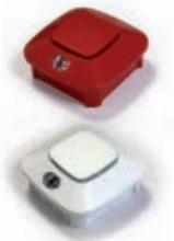
Sirena con funciones de voz que trabaja a partir de 18 a 30 VCC, grado de protección IP65. El programador manual EITK2000 puede configurar los mensajes de tono o alarma eligiendo de la 14 tonos y 16 mensajes de voz en 8 idiomas diferentes disponibles dentro del dispositivo y ajustar el volumen. A través de EITK2000 y también puede personalizar los tonos/mensajes de voz.
