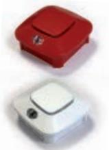
Sirena óptico/acústica que trabaja a partir del 18 a 30 VDC, grado IP65 de la protección. Por El programador manual EITK2000 puede configurar el tono de alarma eligiendo entre 14 disponibles, ajustar el volumen y la potencia del flash.
