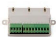
El módulo EM312SR se conecta directamente al bucle y dispone de una entrada supervisada (para control de los dispositivos externos), una salida supervisada (para controlar uno o más dispositivos de señalización acústica u óptica/visual) y una salida de libre intercambio (que permite controlar cualquier dispositivo externo como electromagnetos, etc.).
