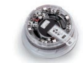
Sirena y flash integrados en la base direccionada adecuada para la conexión al circuito de detección de la central de incendio. ES posible utilizar un detector directamente en la sirena y crear un único dispositivo con una dirección diferente. La dirección a la sirena se configura mediante interruptor dip en su interior. también SE puede seleccionar la intensidad del volumen del sonido. Se suministra de color blanco. La sirena no necesita de alimentación adicional. Con aislador incorporado.
