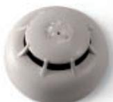
El detector se suministra en modo A1R (umbral fija a 58 ° C y detección termovelocimétrica), puede ser configurado (mediante el controlador EDRV1000) en modo: B (Umbral fijo a 72°C); modo A2S(Umbral fijo a 58°C); modo BR (Umbral fijo a 72°C con detección termovelocimétrica). Gracias a su alta versatilidad puede usarse en todas las condiciones donde sea difícil detectar el humo o se corra el riesgo de una falsa alarma.
