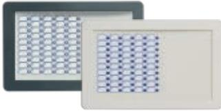
Módulo con 50 LED de 3 colores configurables (verde, amarillo y rojo), para obtener una visualización inmediata del estado de una serie de elementos (zonas, puntos, etc.). Si se coloca en la ranura superior, se instala en el panel frontal y se conecta a la barra CAN DRIVE, mientras que si se coloca en la ranura inferior se conecta al módulo FPM de la ranura superior.
