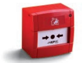
Pulsador manual analógico en contenedor termoplástico de color rojo, del tipo CON REARME. La dirección se programa mediante "DIP" colocados en el interior del botón. Se suministra una llave especial tanto para la prueba como para el rearme del pulsador. Un led rojo encendido indica un estado de alarma. Con aislador incorporado.
