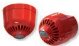
Alarma óptico-acústica con parte óptica certificada según la nueva norma EN54-23, grado de protección IP65 (Versión con base profunda), que funciona de 17 a 60 Vdc, con base de montaje. Tono seleccionable entre los 32 disponibles mediante interruptores DIP switch interno, la frecuencia de parpadeo 0,5Hz/1 Hz (seleccionable con DIP SWITCH), volumen que se puede
