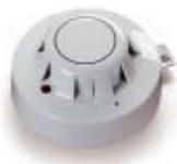
Detector óptico de humo con inteligencia en contenedor de bajo perfil de color blanco, preparado para la instalación de bayoneta en la base direccionada. Con led de señalización de estado y salida remota capaz de suministrar 17 mA máx. Tensión de funcionamiento 14-28 Vcc (insensible a la polaridad de alimentación) y protocolo Apollo Discovery. Cámara óptica desmontable para facilitar la limpieza y el mantenimiento. Construido con protección anti-extracción.
