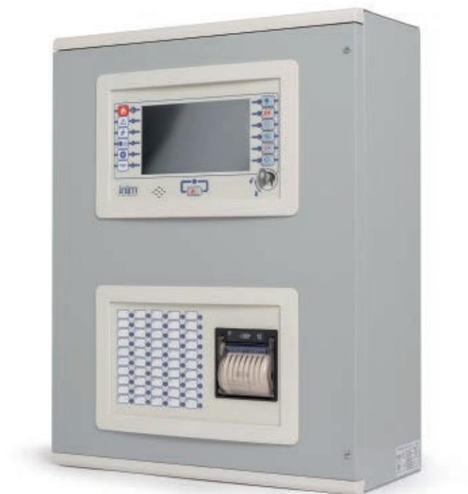
Previdia es un sistema modular para la realización de sistemas de detección y extinción de incendios. Las centrales Previdia pueden constar de uno o varios armarios (máx. 4) enganchados entre sí. Las centrales pueden usarse en forma individual o interconectadas en una red. La conexión en red puede efectuarse mediante BUS RS485, conexión TCP-IP o ambas combinadas.
