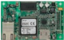
**SmartLAN – Interfaz Ethernet para la programación y el control a distancia y servidor web**
