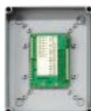
**VMCZ100** Permite conectar al bucle una línea de productos convencionales (Detectores, botones, etc.). Módulo alojado en el interior de una caja (suministrada) 130x95x60 con grado de protección IP66.
