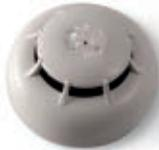
El medidor puede ser configurado en modo: A1R (umbral fijo a 58 °C y detección termovelocimétrica), B (Umbral fijo a 72 °C), A2S (Umbral fijo a 58 °C), BR (umbral fijo a 72 °C con detección termovelocimétrica). Gracias a su alta versatilidad puede usarse en todas las condiciones donde sea difícil detectar el humo o se corra el riesgo de una falsa alarma.
