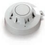
Detector óptico de humo analógico en contenedor de bajo perfil de color blanco, preparado para la instalación de bayoneta en la base direccionada. Con led de señalización de estado y salida remota capaz de suministrar 17 mA máx. Cámara óptica desmontable para facilitar la limpieza y el mantenimiento. Construido con protección anti-extracción.
