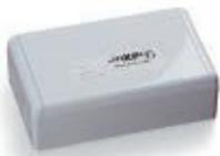
Módulo de una entrada y una salida, adecuado para conectar los contactos normalmente abiertos (barreras, sensores de gas, etc.). La línea de entrada está supervisada y controla tanto el corte como el cortocircuito de la línea. La salida con relé con contactos libres de tensión (Común -Norm. Cerrado - Norm. Abierto). Un Led de color rojo indica la condición de alarma de la interfaz. Incluye aislador.
